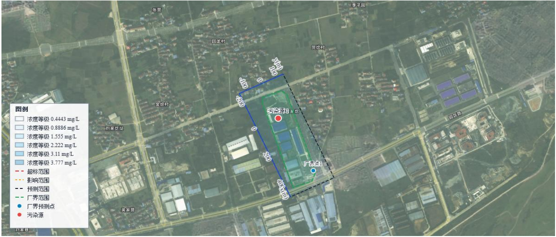
图 6.2.2-12 污染物总磷泄漏 60 天后迁移范围
