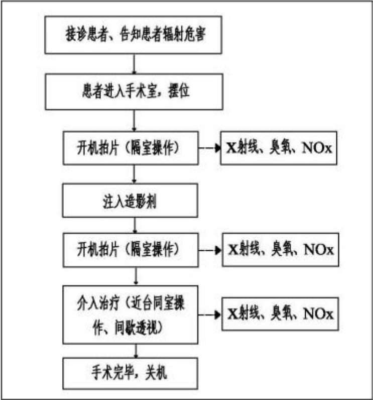
图 9-4 DSA 诊疗流程及产污环节示意图
