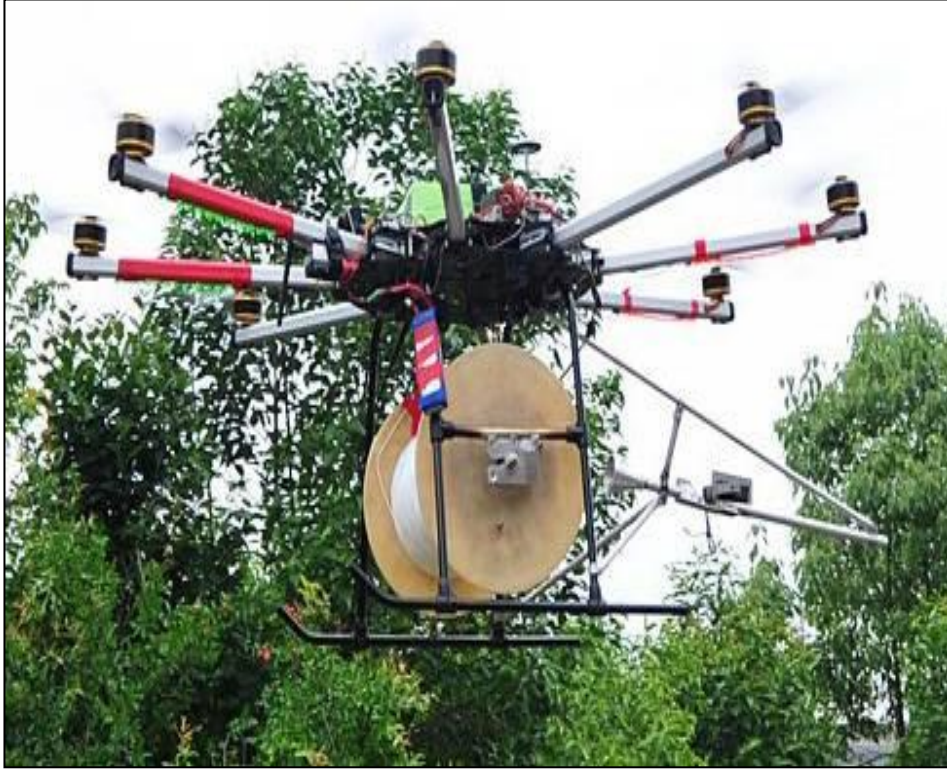
图2-6 八旋翼飞行器放线
