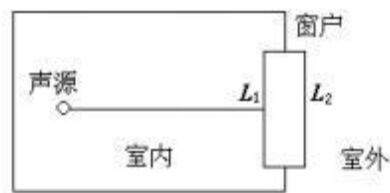
图 5.2-2 室内声源向室外传播示意图
