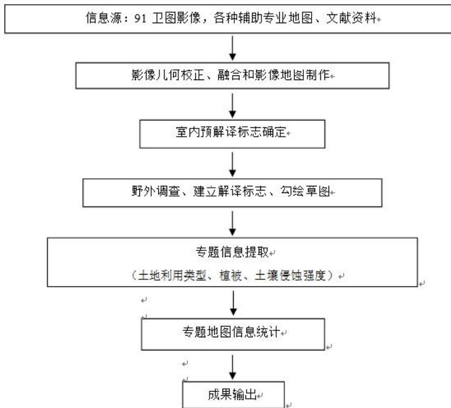
图 4.2-1 遥感影像解译处理流程图
