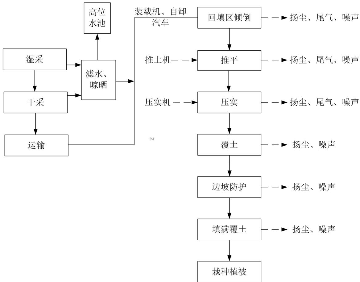
图 3.1-1 项目施工期工艺流程及产污环节图
